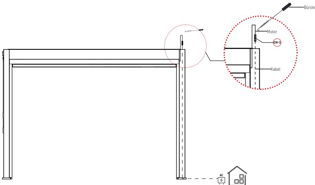
1. Führen Sie nach dem Anschließen die beiden Kabel in den Pfosten ein;
