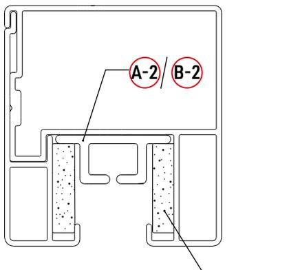
Bei der Installation des elektrischen Sonnenrollos müssen Sie sicherstellen, dass der Schaumstoff in die Nut des A-2/B-2 eingeführt wird.
