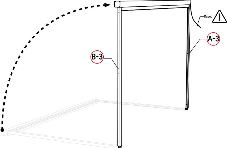
**Setzen Sie den Sonnenrollorahmen an die Pergola. Stellen Sie sicher, dass die Kabelseite mit dem Loch übereinstimmt.**
