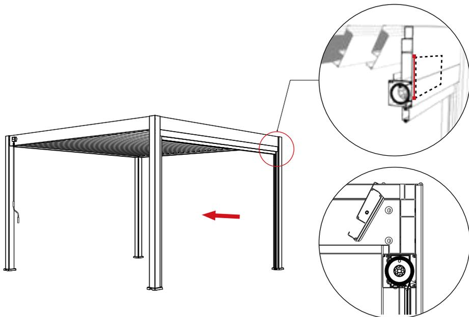
Setzen Sie den Rahmen hoch und stellen Sie sicher, dass die Außenseite des Sonnenrollkastens mit der äußeren Fläche des Trägers übereinstimmt.
