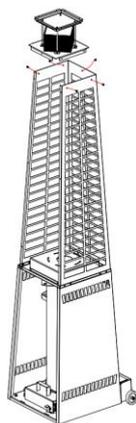
**Schritt 6: Verwenden Sie 16 M4,8-Schrauben, um die Regenabdeckung zu montieren**
